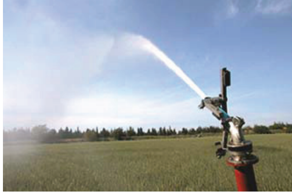
Şekil 18. Yüksek kapasiteli ve yüksek basınçla çalışan yağmurlama başlığı
