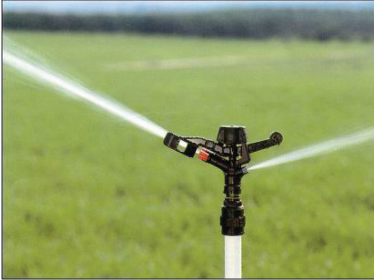
Şekil 17. Yükseltici üzerine yerleştirilmiş döner yağmurlama başlığı
